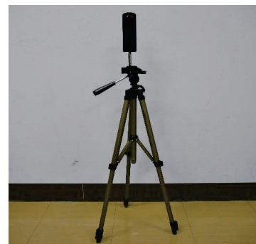
写真4 360度カメラとエクステンションアダプターでつないだ三脚
